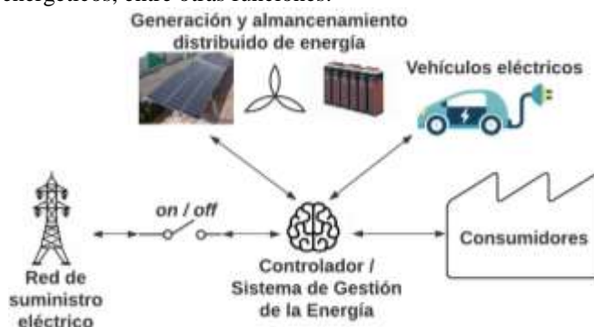
Fig. 1. Esquema conceptual de una microrred.
