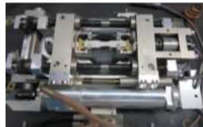
Fig. 10. Prueba de resistencia a la tensión del cerámico
