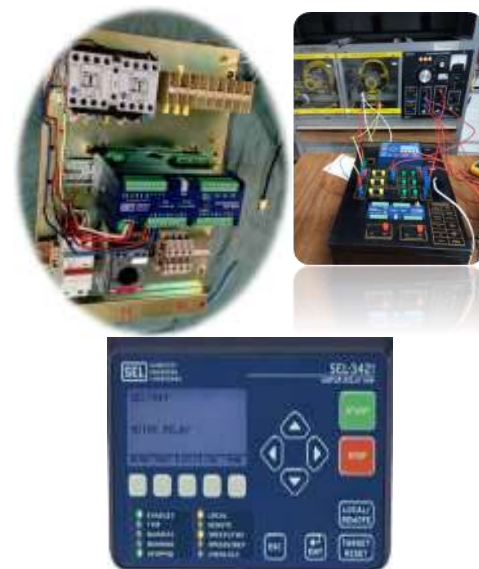
Figura 3. Módulo didáctico de relevador digital de protección de Motores de Inducción
