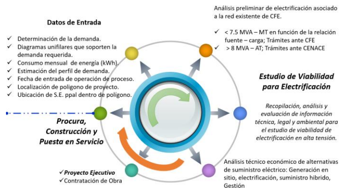
Fig. 3. Proceso de Planeación de la Electrificación
