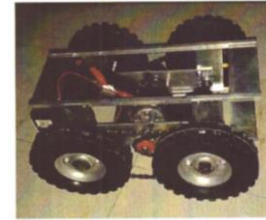
Figura 5 Chasis, transmisión y batería incorporados al sistema.
