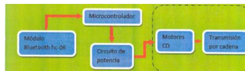
Figura 1 Diagrama de bloques de la plataforma móvil.
