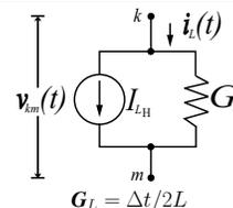
$G_L = \Delta t/2L$ $i_L(t) = I_{L_H}(t - \Delta t) + G_L(v_L(t))$ $I_{L_H}(t - \Delta t) = i_L(t - \Delta t) + G_L(v_L(t - \Delta t))$                                                                               |
