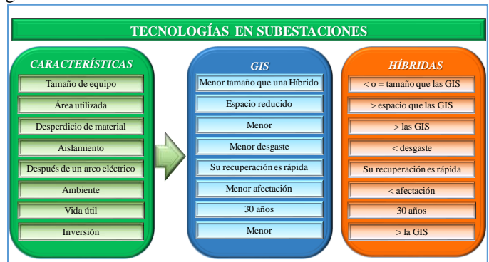
Figura 4. Comparativa de tecnologías en subestaciones (GIS e Híbridas) según [8].
