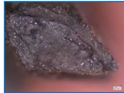
Foto 7. Rejilla de placa positiva, corrosión , al microscopio 100 µm.
