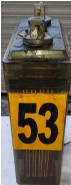
Foto 3. Celda de 2v Foto 4. Grietas tapa y poste positivo
