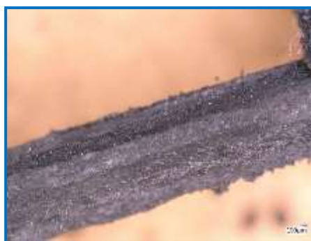
Foto 10. Material Rejilla placa negativa, al microscopio 100 \mu m .
