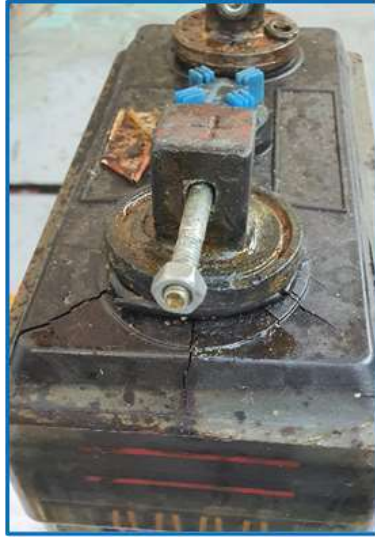
Foto 3. Celda de 2v Foto 4. Grietas tapa y poste positivo
