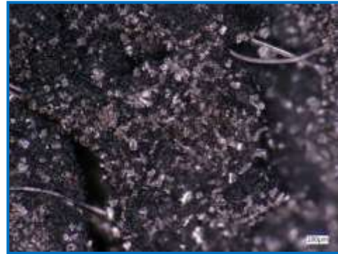
Foto 6. Cristales de sulfato del material activo, color blanzuzco, al microscopio 100 µm.
