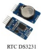
Fig. 5. Módulo utilizado para establecer tiempos en el sistema de control.
