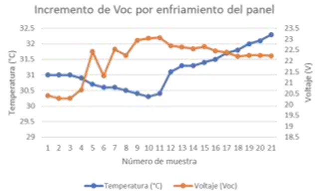
Fig. 21. Incremento del V_{oc} por enfriamiento del panel.
