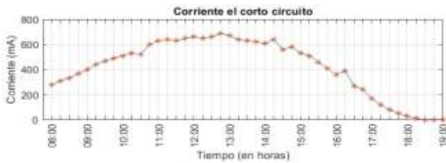
Fig. 9. Gráfica de corriente en corto circuito ( I_{SC} ) al aire libre.
