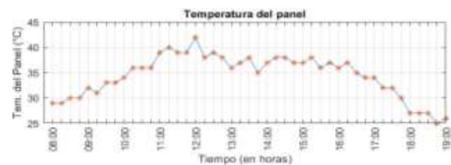
Fig. 11. Gráfica de temperature del panel al aire libre.
