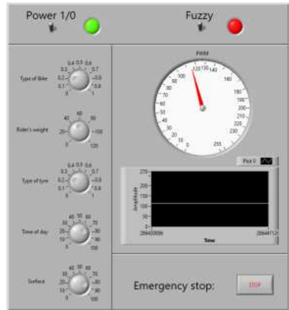
Fig. 14 Panel de control para controlador lógico difuso, control crucero en LabVIEW
