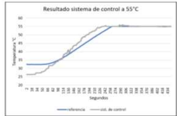
Figura 8. Resultado del sistema de control al llegar a 55°C
