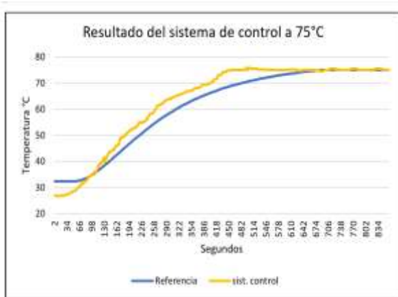
Figura 6. Resultado del sistema de control al llegar a 75°C
