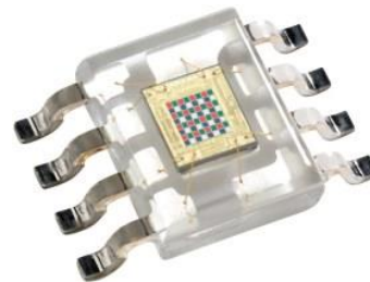
Fig. 1. Acercamiento del Chip TSC3200.
