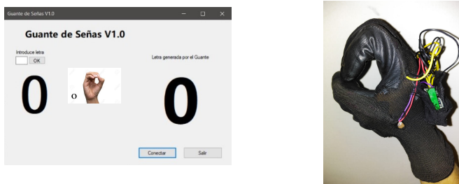
Figura 10. Captura de la interfaz gráfica junto con la letra "O" realizada en el guante
